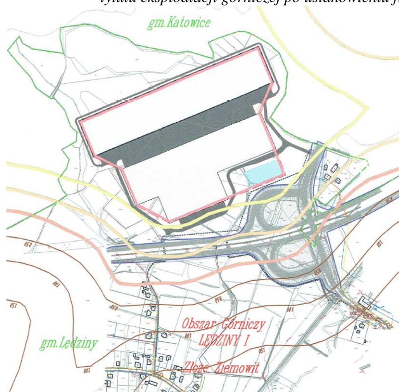
Rysunek 13 Mapa sytuacyjno-wysokościowa powierzchni terenu naniesionymi wpływami z tytułu eksploatacji górniczej po ustanowieniu filara ochronnego
